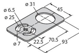
Монтажные зажимы, нерж. сталь, для датчиков с резьбой 30 мм
