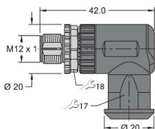
Connecteur mâle confectionnable, M12 x 1, coudé, 5 pôles, raccordement par borne à vis, diamètre de ligne 4,0 à 8,0 mm, section conducteur/section raccordable 0,25 à 1,5 mm<sup>2</sup>, boîtier plastique, vis de montage métallique
