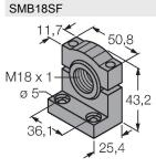
bride de fixation, noir PBT, pour les détecteurs à filetage 18 mm, orientable
