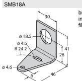
3033200 bride de fixation, coudée, acier inoxydable, pour les détecteurs à filetage de 18 mm
