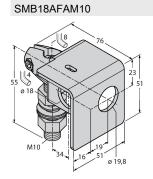
3012558 équerre de montage, matériau VA 1.4401, pour filetage 18 mm, filetage M10 x 1,5
