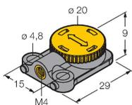
Transmetteur de position mobile pour détecteurs de positionnement linéaire LI-QR14 et LI-Q17L ; fixation radiale et axiale possible ; distance nominale par rapport au détecteur de 1,5 mm ; coupleur avec détecteur de positionnement linéaire à une distance maximale de 3 mm ou un décalage transversal maximal de 3 mm
