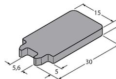
Défreinor des éléments de montage pour détecteurs de positionnement linéaire LI-Q17L
