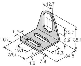
Équerre de fixation pour détecteurs à tube fileté ; matériau : acier inoxydable A2 1.4301 (AISI 304)
