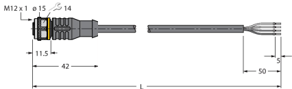
Dibujo acotado Tipo N.º de ID RKC4.4T-2/TEL 6625013
