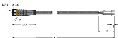
Dibujo acotado Tipo PKG4M-2/TEL N.º de ID 6625061
