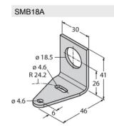
Soporte de montaje, en ángulo recto, acero inoxidable, para sensores con rosca de 18mm
