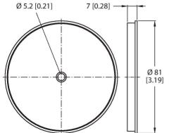
Reflector redondo, coeficiente de reflexión 1,0, material acrílico, temperatura ambiente de -20...+60 °C
