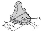
Soporte de montaje para los sensores de posición lineal LI-Q17L; material: aluminio; 3 unidades por bolsa
