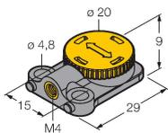
Transductor de posición libre para sensores de posición lineal LI-QR14 y LI-Q17L; se puede fijar de manera transversal y longitudinal; la distancia nominal al sensor es de 1,5 mm; se empareja con el sensor de posición lineal a una distancia de hasta 3 mm o un desplazamiento transversal de hasta 3 mm.
