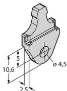
Base de montaje para los sensores de posición lineal LI-Q17L; material: aluminio; 3 unidades por bolsa
