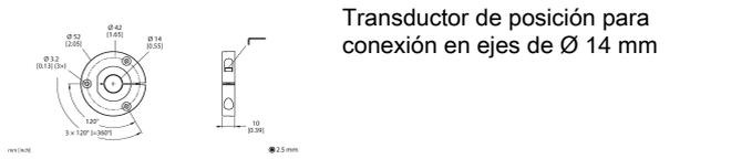
Transductor de posición para conexión en ejes de Ø 14 mm
