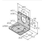
Montagewinkel, rechtwinklig, Edelstahl, für Sensoren mit 30 mm Gewinde, weite Bohrlöcher zur genauen Ausrichtung
