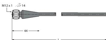
Anschlussleitung, M12-Kupplung, gerade, 5-polig, Edelstahlüberwurfmutter, Leitungslänge: 2 m, Mantelmaterial: TPE, grau; Temperaturbereich: -40...+105 °C
