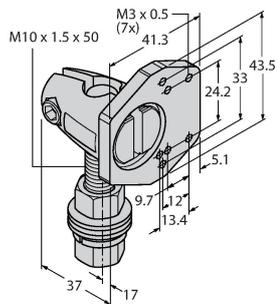
Montagehalterung, drehbar, Edelstahl, für Sensoren der Baureihe Q4X/Q3X, Gewinde M10 x 1.5
