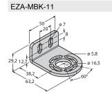
Montagewinkel, schwarz, Stahl, für EZ-ARRAY und EZ-SCREEN Standard und Kaskade 14 & 30 mm
