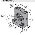
Montagehalterung, PBT-schwarz, für Sensoren mit 30-mm-Gewinde, ausrichtbar
