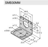
Montagewinkel, rechtwinklig, Edelstahl, für Sensoren mit 30 mm Gewinde, weite Bohrlöcher zur genauen Ausrichtung
