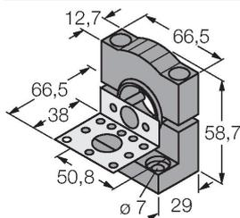
Montagewinkel, PBT-schwarz, mit Montageplatte, Edelstahl, für Bauformen mit 18mm Gewinde, QM42/QMT42
