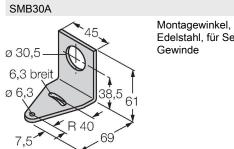
Montagewinkel, rechtwinklig, Edelstahl, für Sensoren mit 30mm Gewinde
