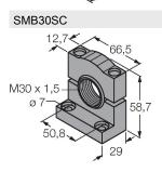
Montagehalterung, PBT-schwarz, für Sensoren mit 30-mm-Gewinde, ausrichtbar
