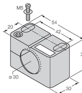
Befestigungsschelle für Gewinderohrsensoren, mit Festanschlag; Werkstoff: PA6
