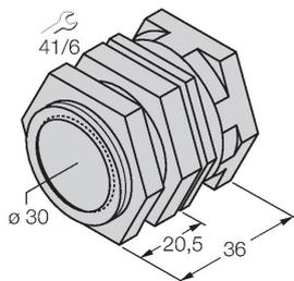
Schnellmontagehalterung mit Festanschlag; Werkstoff: Messing verchromt. Außengewinde M36 x 1,5. Hinweis: Der Schaltabstand der Näherungsschalter kann sich durch Verwendung von Schnellmontagehaltern ändern.
