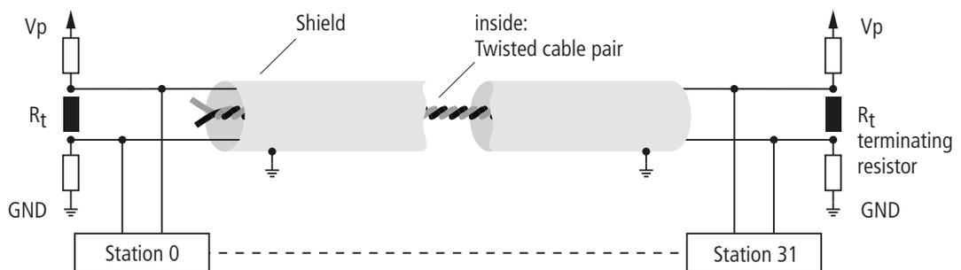
Fig. 1: Schematic PROFIBUS-DP cables
