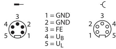
Keine galvanische Trennung von  $U_L$  und  $U_B$  beim FGEN-XSG16-5001!
