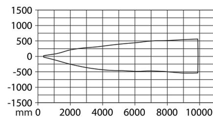
Fig. 16: LRS510-...-57-..., LRS510-...-69-... range diagram
