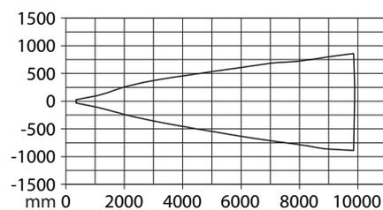
Fig. 15: LRS510-...-34-..., LRS510-...-51-... range diagram
