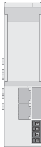
Abb. 5: Direkt-Steck-Kontakte zum Anschluss der Versorgungsspannungen
